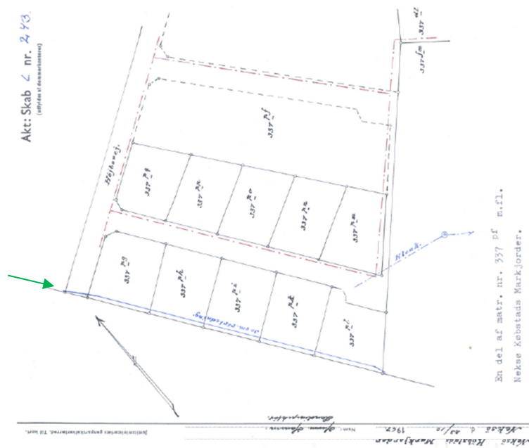
Figur 5: Kort fra tingbogen, der viser udstykningen af parcelhusgrunde i området (1967). Den blå sammenhængende streg svarer til del 3, af rørledning. Den stiplede blå streg er en kloakledning. De røde streger antages at være vandledninger.
