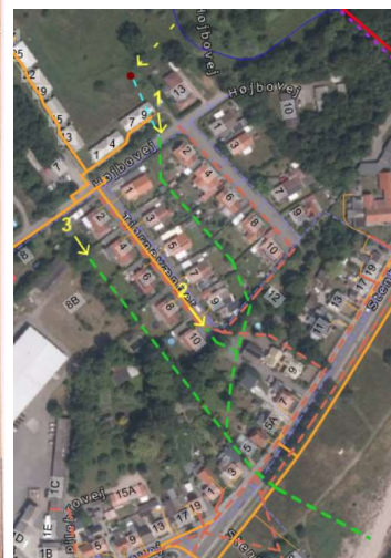
Figur 4: Situationsplan for Møllebakke kvarteret med kloakledninger og vandledninger (1965). Kloakledningen ligger i samme trace som del 1 af rørledningen (blå pil). Til sammenligning se kortet til højre, der viser ledningens trace i dag.
