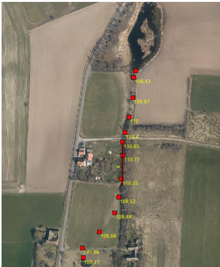
Figur 3: De røde punkter er placering af målepunkter. De gule tal tilknyttet punkterne, er koten (meter over havets overflade), for de målte punkter.
