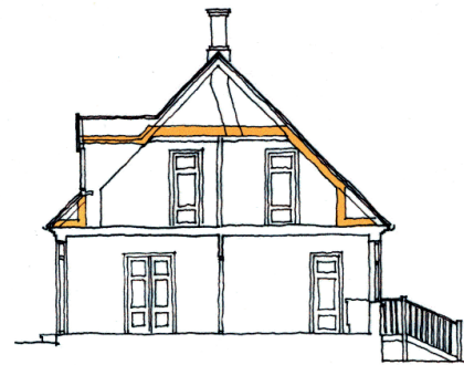
III.4. Ved isolering af tagetagen, bør der isoleres så tæt som muligt på det område der skal varmes op.
